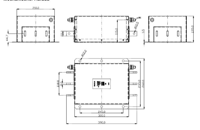
Einbaulage mit Anschlüssen oben oder unten, nicht seitlich!
